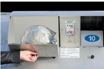
Nach dem Schließen des Einwurfschachtes verriegelt die Anlage automatisch. Die entsorgte Müllmenge wird Ihrem Transponder zugeordnet.
